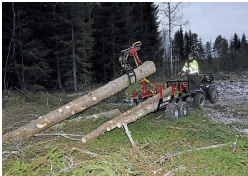
↑ Tapiolle tämä kuorma alkoi olla jo ylivoimainen. Puut saatiin kyllä kyytiin, mutta ilman vetoa kuorman liikuttelu alkoi olla hankalaa.
