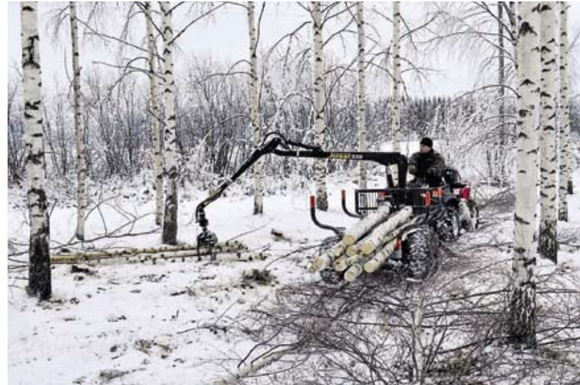
↑ Vahva-Jussin puomisto on mittakaavassa pienennetty isommasta kuormaajasta, nostossa on voimaa suoralla varrella ryhmästä eniten.
