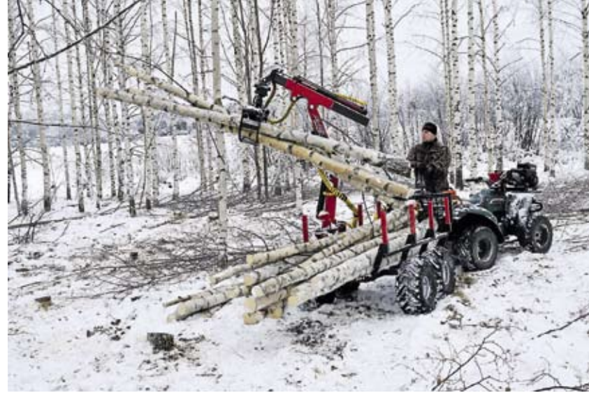
↑ Metsä-Tapiolla voidaan käytännössä kuormata vain takaa katsoen vasemmalta puolelta, vaunun suuntaisesti olevan kasan kuormauksessa nosturi on todella nopea.
