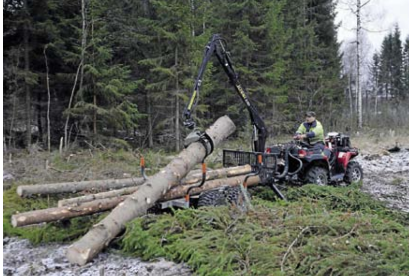
↑ Tämä tukki ei enää noussut yhdelläkään kuormaajalla suoraan kyytiin. Latvan halkaisija oli 27 cm, pituus 4,6 m. Jussi suoriutui nostosta parhaiten.
